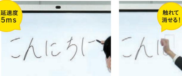
筆記速度を感知し、太さ、ストロークを精密に再現。画面に触れるだけで消すこともできます。また画面に映した資料に直接書き込むこともできます。
